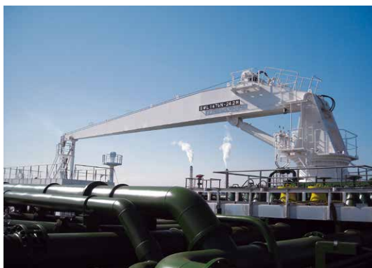
油圧式ホースハンドリングクレーン(15TON×24.2MR) Hydraulic type hose handling crane
