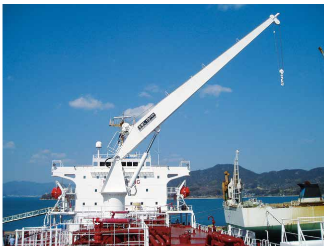
油圧式ホースハンドリングクレーン(10TON×19MR) Hydraulic type hose handling crane
